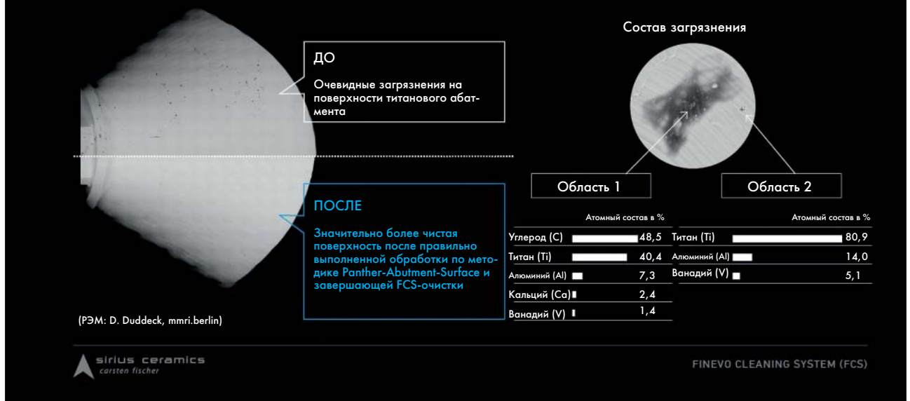
Рис. 3. Finevo Cleaning System (FCS) представляет собой проверенную трехступенчатую технологию ультразвуковой очистки, которая в последние годы благодаря своей практичности и невысоким затратам пользуется все большей популярностью.
